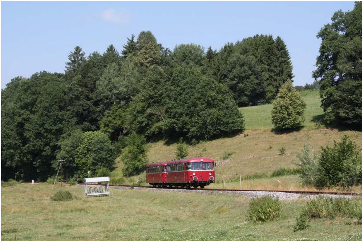
Zum Einsatz kommt eine zweiteilige deutsche Schienenbus-Garnitur bestehend aus VT 98 und VS 98, wie sie auf der Ilztalbahn zu Zeiten des planmäßigen Verkehrs durchaus typisch gewesen ist.
